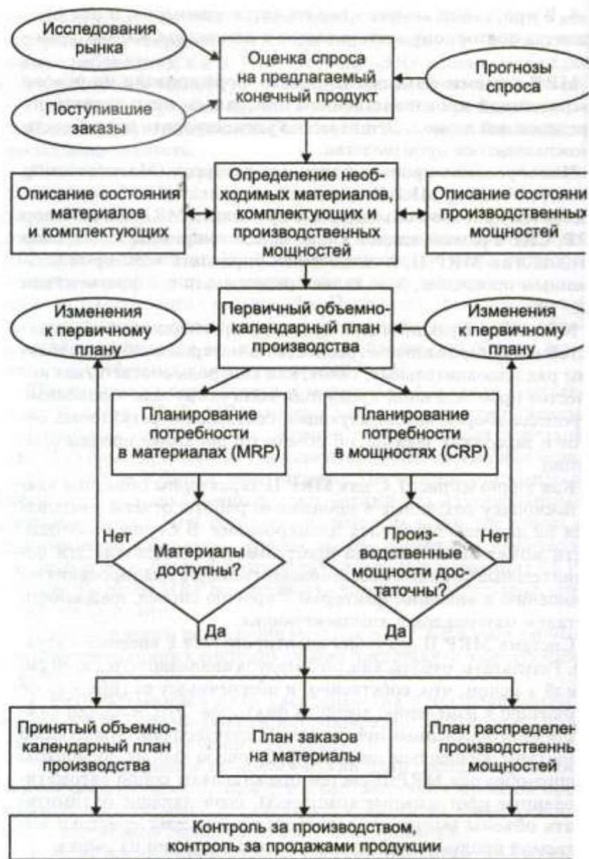
Рис. 3.3. Схема функционирования методологии MRP II
